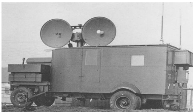
Рисунок 6. – Система идентификации Mk. III была намного меньше и гораздо мобильнее, чем Mk. II
