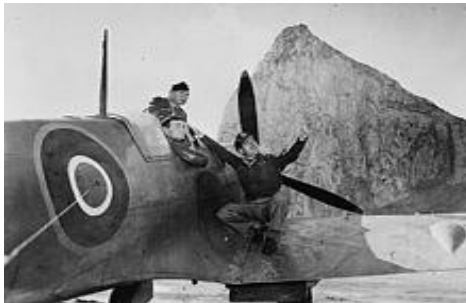
Рисунок 3. – Проволочная антенна системы идентификации, соединяющаяся с фюзеляжем в центре опознавательного знака Королевских ВВС. Антенны размещены по обеим сторонам фюзеляжа. Вес антенн 18 кг
